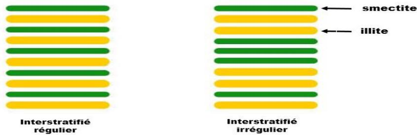
**Figure I 11:** Association au sein d'une même cristallite, de feuillets de nature différente ; Illite/Smectite [25].
