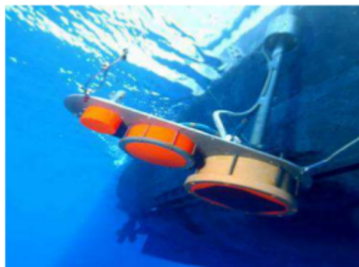
Figure 8: Sondeur acoustique sur la partie latérale d'un navire (Habasque J., 2015)
