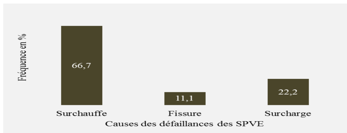
Figure III.11 : Histogramme des défaillances des SPVE dans la région de Fatick.
