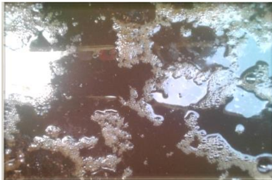
Figure 2. 10 : Illustration de digestat à surface peu moussant au niveau du BioC (chambre de sortie)
