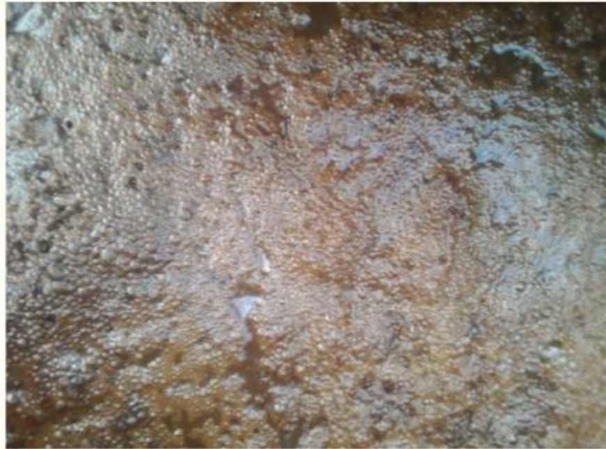
Figure 2. 9 : Illustration de digestat à surface moussant au niveau du BioA (chambre de sortie)
