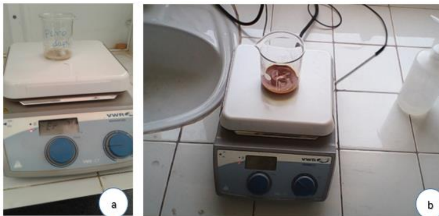
Figure 18 : Dispersion de pérovskites (a) et de pérylène(b) à l'aide d'un agitateur magnétique.
