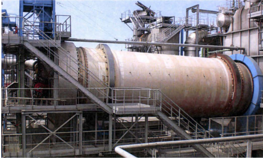
FIGURE 1.3 – Four rotatif ou four tournant avec un diamètre interne de 4,096 m et une longueur de 16 m [6]
