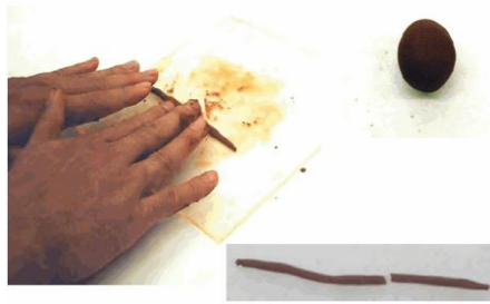
Figure II.7 : Mesure de la limite de plasticité des argiles.
