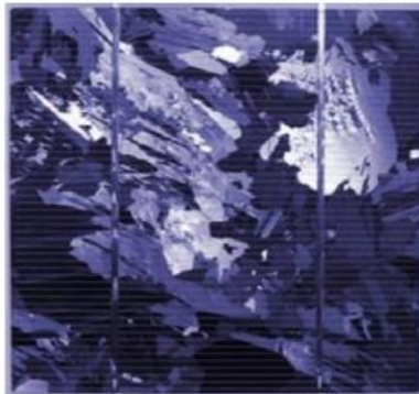
Figure (I-5) : Cellule solaire au silicium polycristallin [9]
