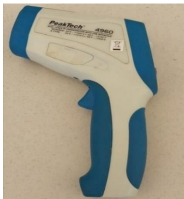
Figure (II-2) : Thermomètre infrarouge de type P4960
