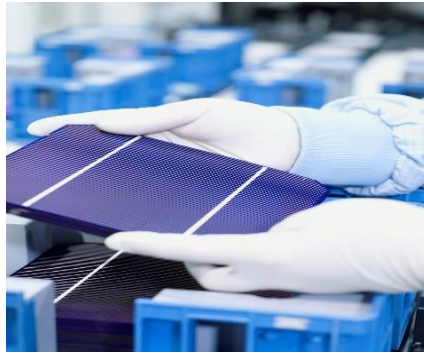
Figure (I-4) : Cellule solaire au silicium monocristallin [9]
