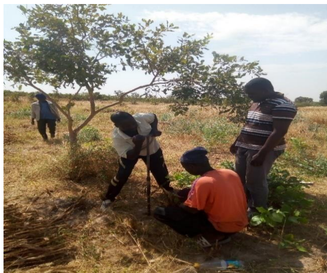
Figure 11: Prélèvement d'échantillons de sol dans le dispositif en milieu contrôlé à Ndiognick/ Sénégal
