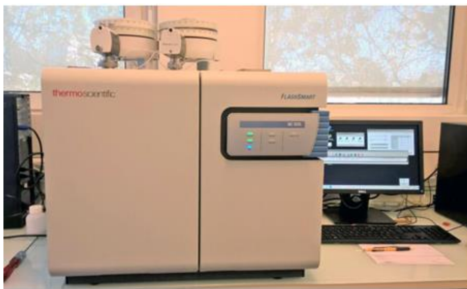
Figure 7 : Analyseur élémentaire Thermo-Finnigan Flash 2000 NC HPAR (Plateforme d'Analyse Chimique en Ecologie, 2023)
