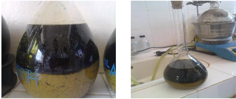
Figure 2 : Macération avec l'éther pétrole
