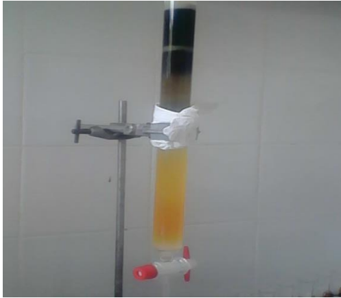
Figure 7 : Colonne en pleine élution
