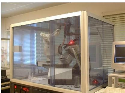
**1 Le diffractomètre KappaCCD à détecteur bi-dimensionnel est implanté au Plateforme de mesures de diffraction et de diffusion des rayons X**
