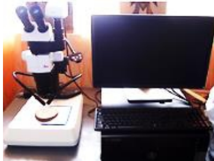
Photo 6 : Loupe binoculaire M80
