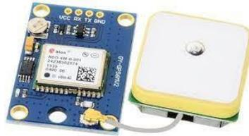
Figure 39: module GPS NEO 6M
