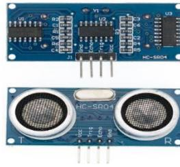
Figure 37: Capteur ultrason HC-SR04
