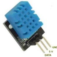
Figure 41: capteur de température et d'humidité
