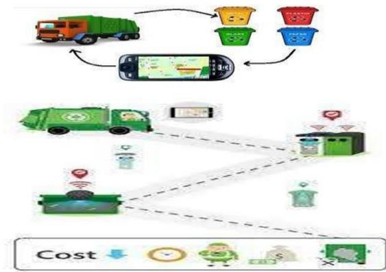
Figure 14 : Architecture de la gestion des déchets utilisant WSN et IoT
