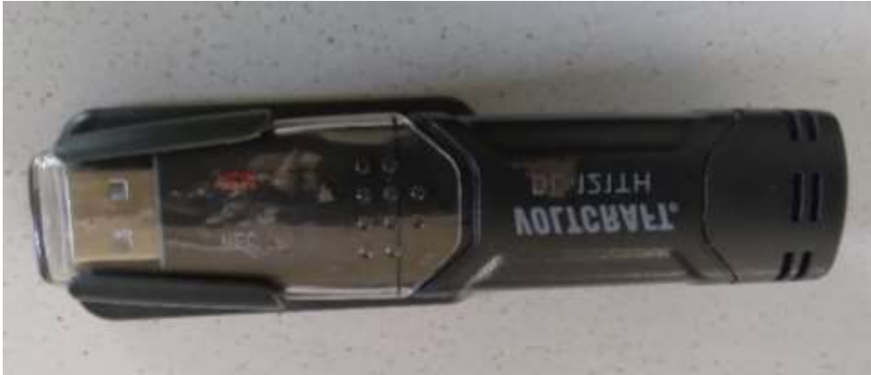
Figure III. 8: Dispositif expérimental de mesures de l'humidité relative : DL-121 TH.
