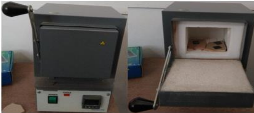
Figure 25: Four thermolyse pour le recuit des échantillons.
