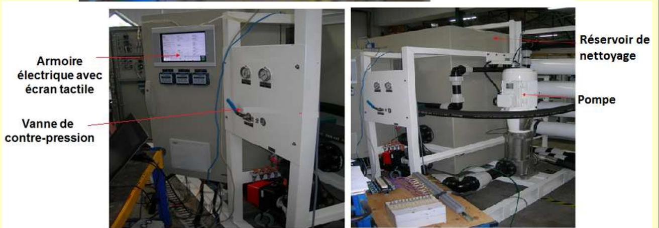
Figure 3 : Module de nanofiltration
