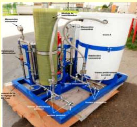
*Figure 4 : Module de filtration [2].*
