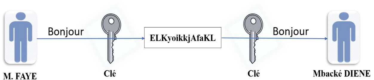
Figure 19 : Schéma de fonctionnement de la cryptographie Symétrique
