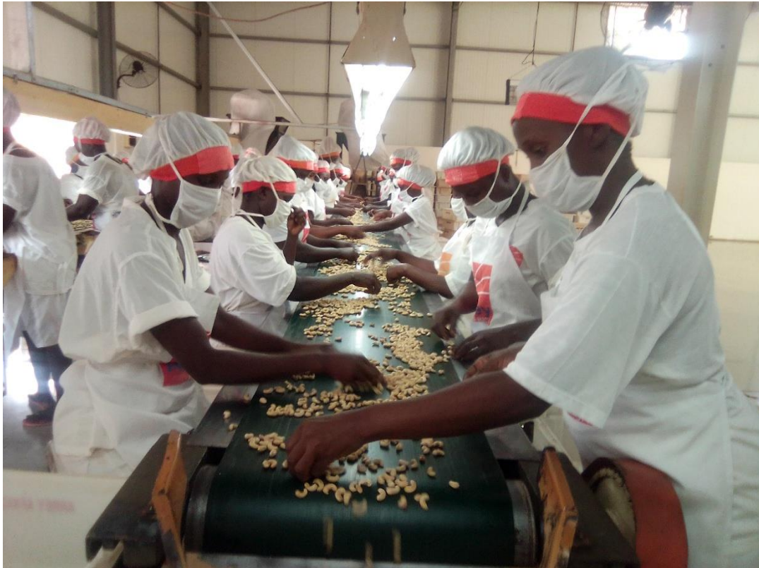
Photo 7 : Le retrait manuel des amandes endommagées en tapis roulants
