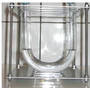
*Figure III-2 : Pont de gel neutre (agar-agar 0,1%) dans un tube en U.*
