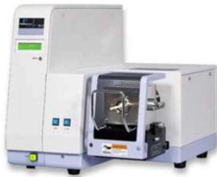
*Figure A3.6 : Photographie de l'appareil TG-DTA couplé.*
