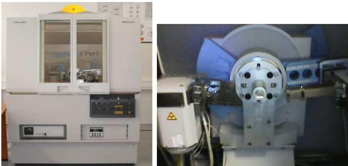
Figure A3.1a : Photographie d'un diffractomètre sur poudre.
