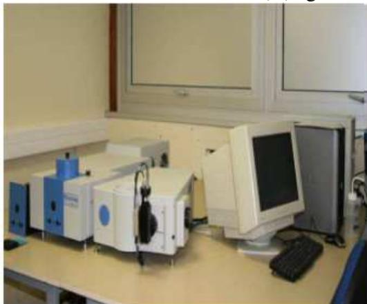
Figure A3.2 : Photographie de l'appareil Horiba Jobin-Yvon Fluorolog III.
