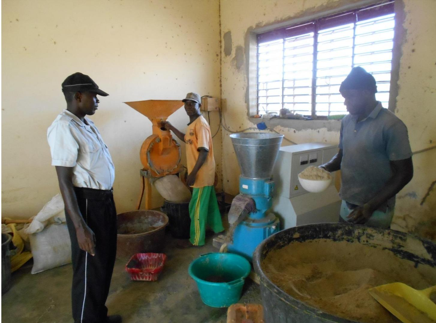
**Photo 3**: moulinage ingrédients et fabrication d'aliment
