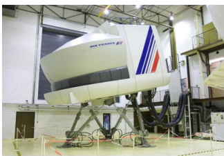
(a) Une plateforme de Gough-Stewart : simulateur de vol Air France B777.
