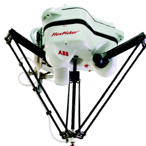
(b) Robot parallèle Delta.
