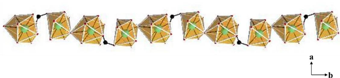
**Figure 30** : Chaîne quasi-linéaire suivant la direction  $[010]$ .
