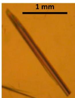
**Figure 18** : Image d'un monocristal en forme d'aiguille de  $\{[Er_2(dcpa)_3(H_2O)_5].3H_2O\}_\infty$ .
