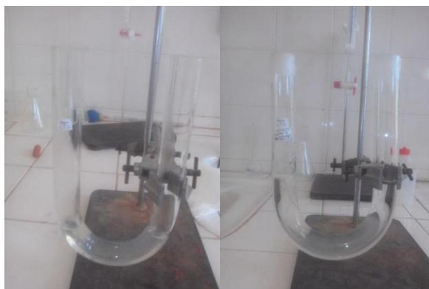
*Figure 11 : Méthode de cristallisation en tube en U.*
