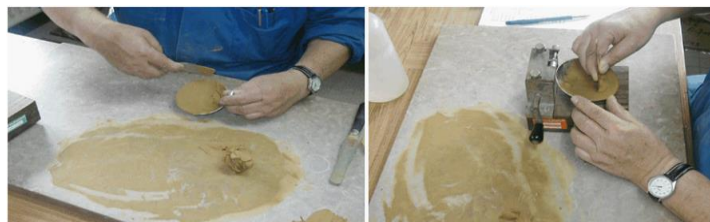
Figure9: Réalisation de la rainure (source CETE)
