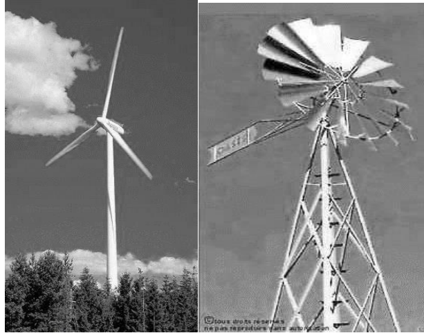
Figure 8 : Eoliennes à axe horizontal [14]
