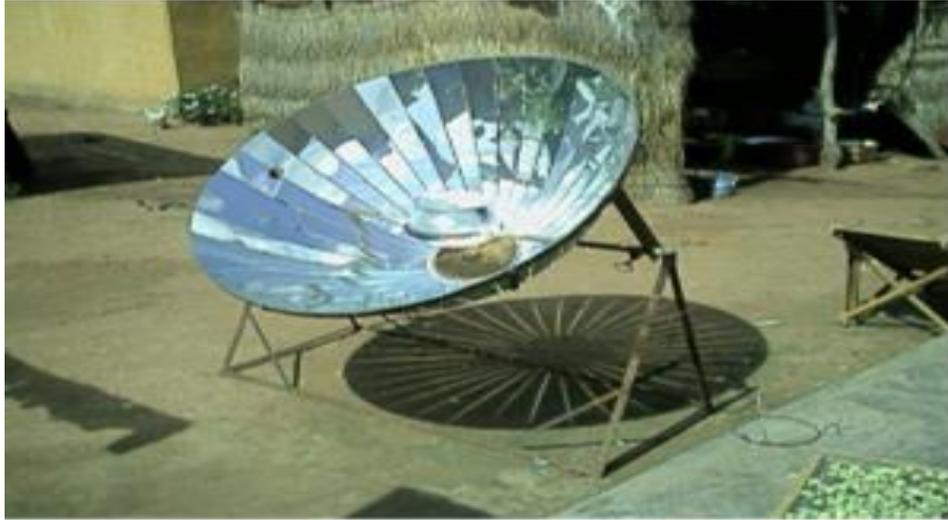
**Figure 1:** Four solaire de type parabolique [4]
