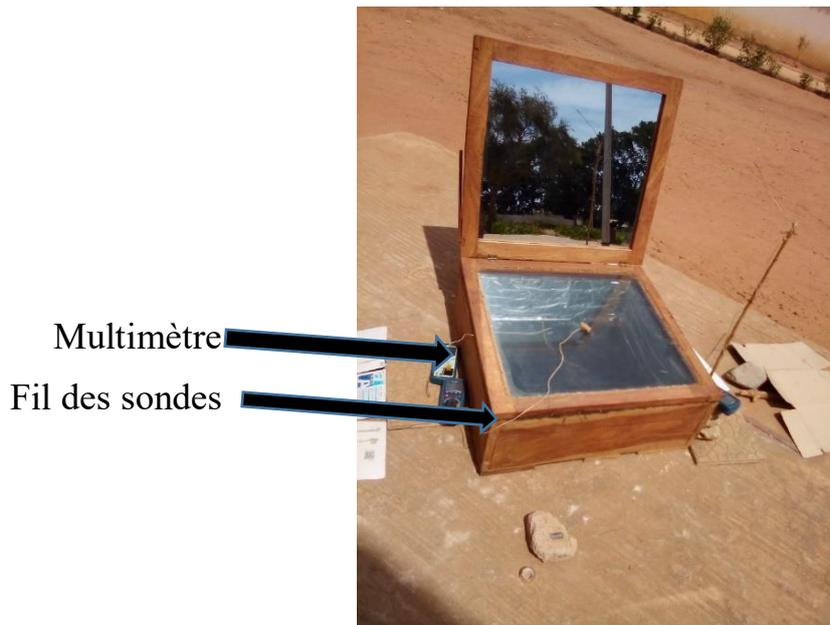
**Figure 8 :** Mesure de la température au milieu interne du four solaire (24/05/2019) à l'Université Assane Seck de Ziguinchor
