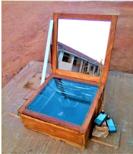
**Figure 10 :** Mesure de la température à l'intérieur de la casserole du four solaire (20/05/2019) au sein de l'université Assane Seck de Ziguinchor
