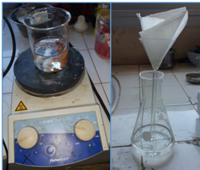
Figure 11 : Dispositif expérimental de la filtration
