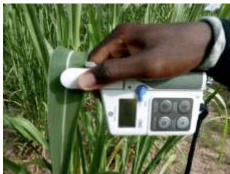
Figure 15 : Mesure de la teneur en chlorophylle à l'aide du Spad
