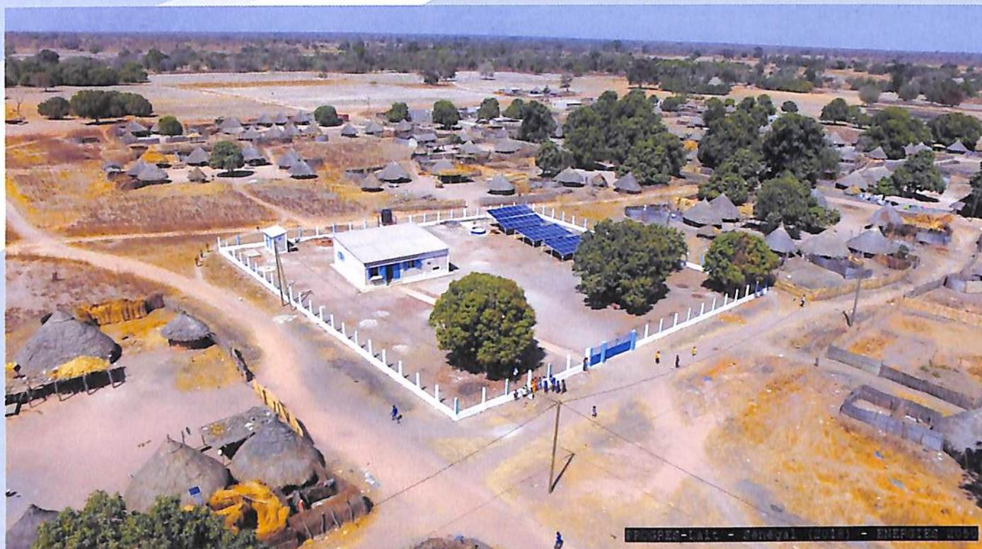
Quatre plateformes solaires (03 grandes et 01 mini) opérationnelles ont été réalisées en Mauritanie et au Sénégal au cours de la phase pilote du programme PROGRES-Lait. Ces plateformes sont toutes autonomes en électricité avec 49,48 kWc solaire photovoltaïque installés et sont équipées de tanks à lait pour le refroidissement et le stockage.
