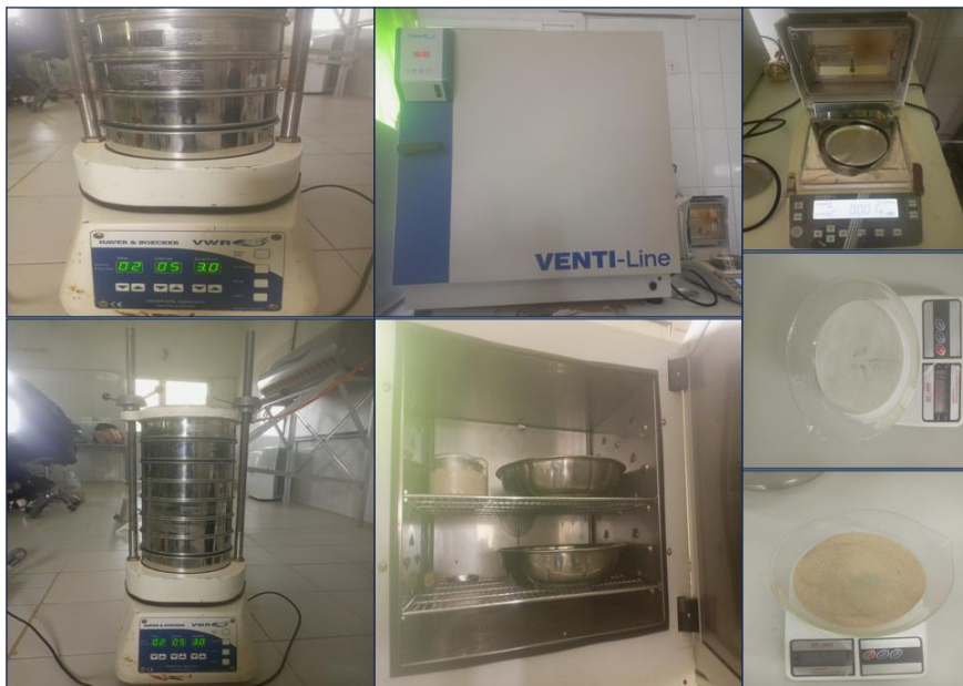
Planche photographique 5: Appareils utilisés pour l'analyse granulométrique au laboratoire du département de physique de l'UASZ
