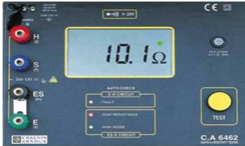
Figure III.3 : l'appareil de mesure de la prise de terre ou Telluromètre
