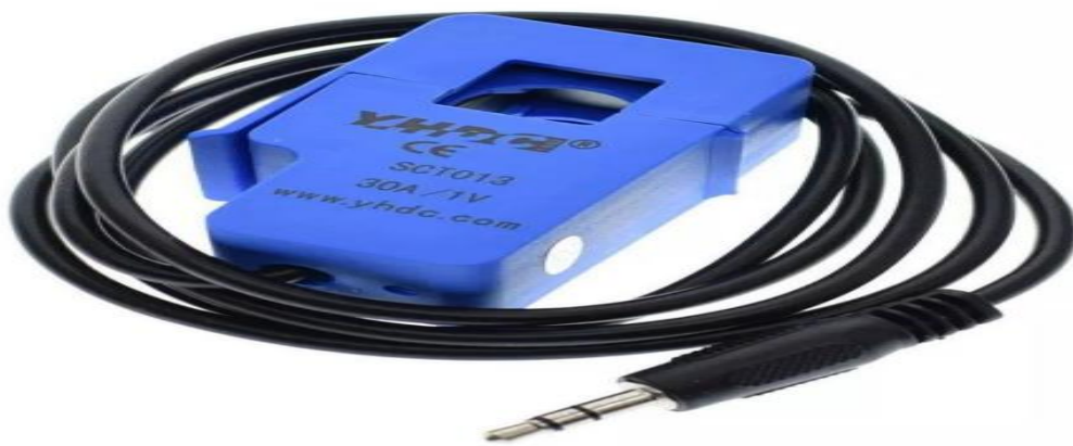
Figure IV.19 : Capteur de courant SCT-013-30
