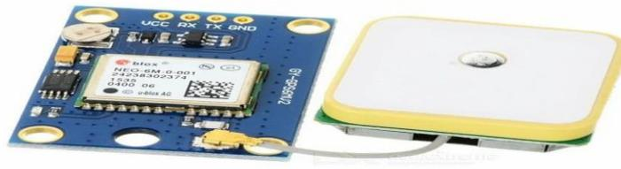
Figure 22 : Capteur de géolocalisation GPS NEO-6M
