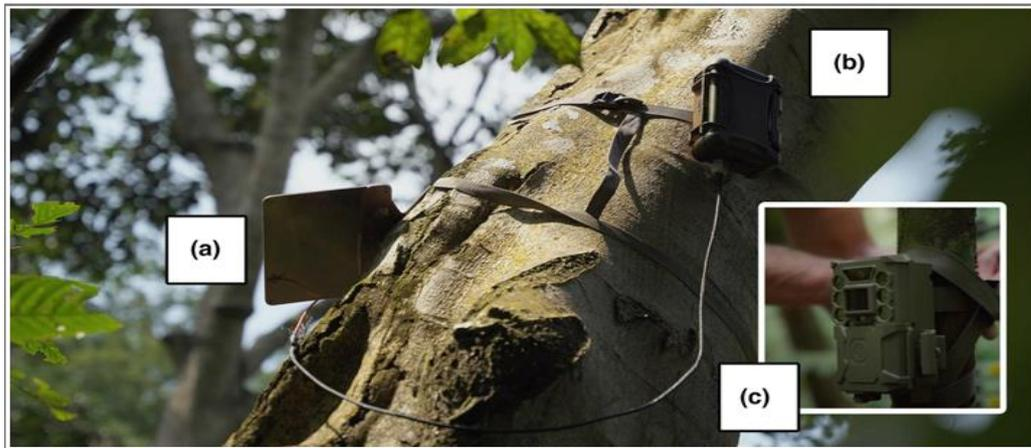
*Figure 13 : Système d'alerte via le réseau satellitaire iridium*
