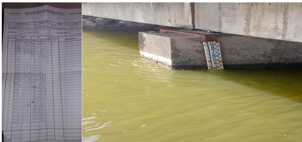
Photo 6 : Image d'un relevé de hauteur d'eau de la station limnimétrique de Djibonker (octobre, 2021)
