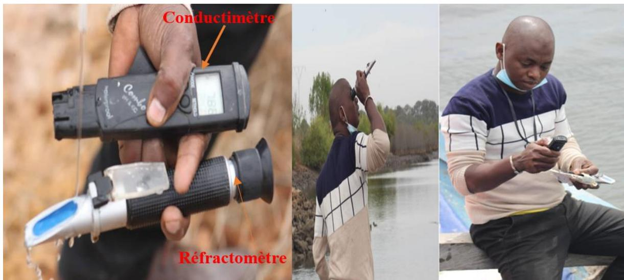
Planche 3: conductimètre et refractomètre
