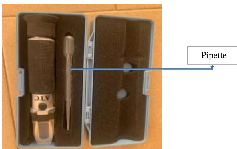
Photographie 1: Réfractomètre utilisé pour mesurer la salinité des eaux (Diatta, Décembre 2021)
