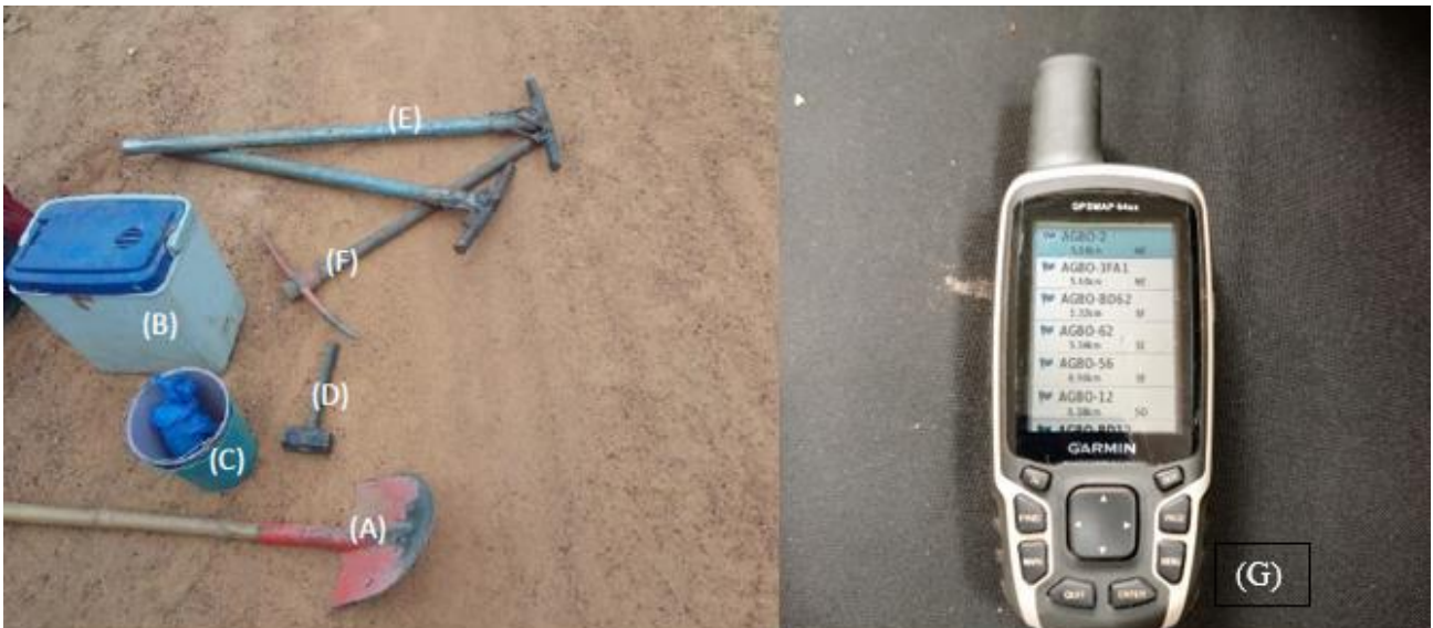
Figure 5: Les outils d'échantillonnage. (A) : pelle, (B) : glacière, (C) : seaux, (D) : marteau, (E) : tarière, (F) : pioche, (G) : GPS.
