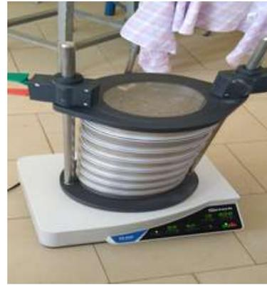
Figure 7: Tamiseuse à vibration
