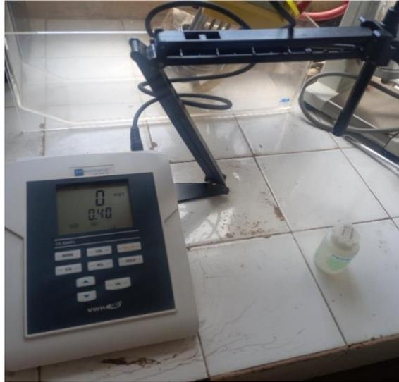
Figure 10: Conductimètre pHenomenal™ VWR3000L
