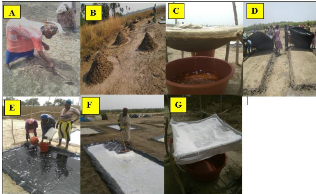
Photo 5 : Différentes étapes de la production du sel solaire dans le village de Boucotte ( Cliché : COLY K., Mai 2020 )
