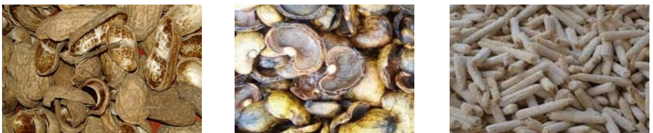
Figure 2.1 : Photos illustrant les biomasses brutes : coques d'arachide (à gauche), coques de cajou (au milieu) et rafles de maïs (à droite)
