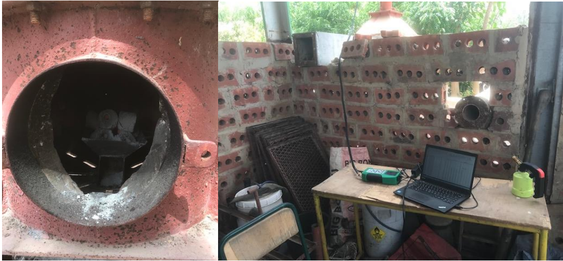
Figure 2.11 : Photos illustrant les tests d'émissions des briquettes de charbon
