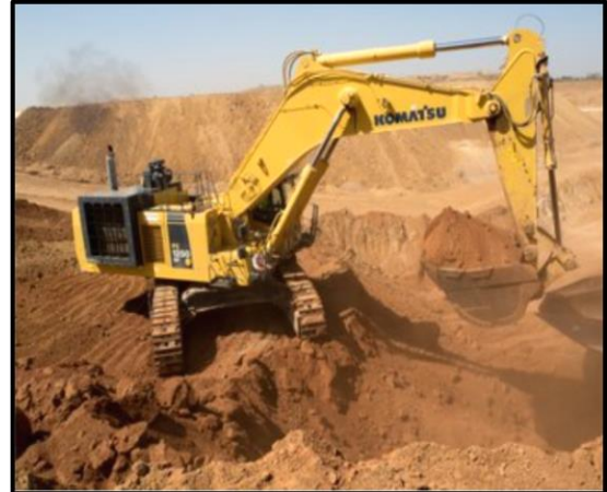
Photo 5 : Extraction du phosphate par système de pelles et camions (Source : SEPHOS, 2018) Photo 6 : Pelle hydraulique à grand godet chargeant les camions (Source: SEPHOS, 2018)
