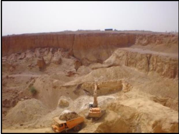
Photo 5 : Extraction du phosphate par système de pelles et camions (Source : SEPHOS, 2018) Photo 6 : Pelle hydraulique à grand godet chargeant les camions (Source: SEPHOS, 2018)
