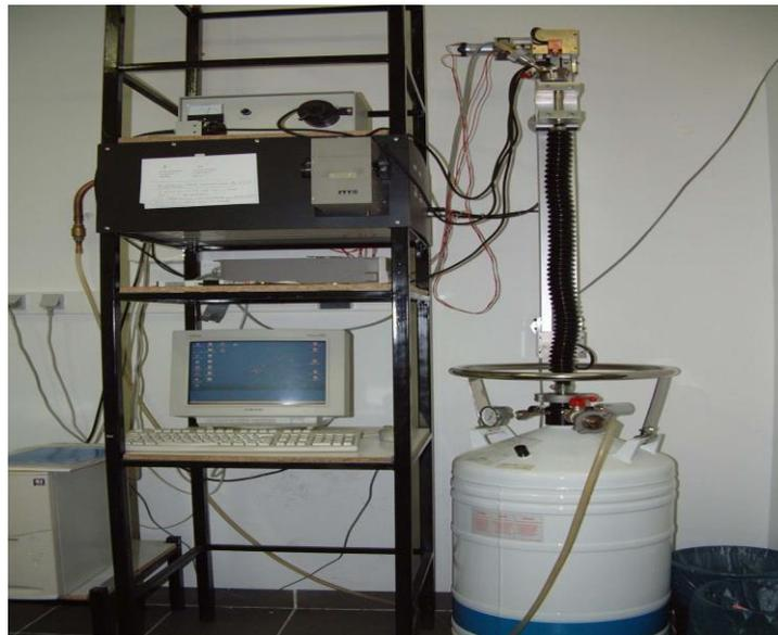
**Figure IV.1.2:** L'appareil de mesure de la réflectivité à hélium.
