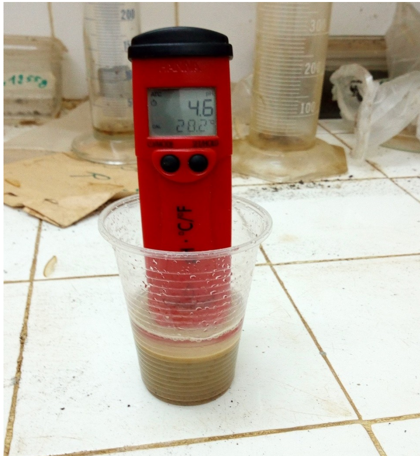
Figure 5: Mesure de ph avec le ph mètre HANNA
