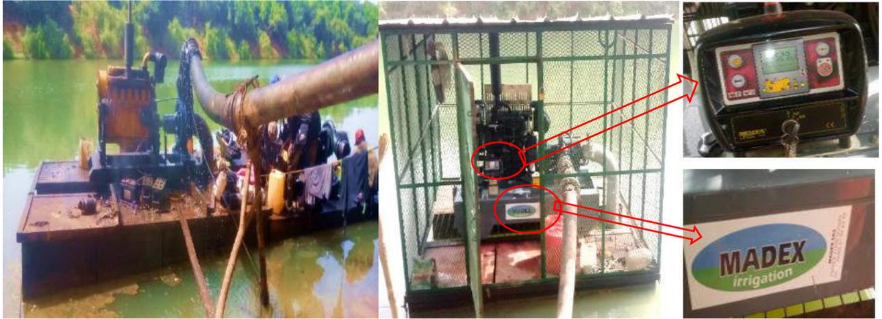
*Photo 9.1. Les GMP d'irrigation ; en raccord (à gauche) et en aspersion (à droite)*
