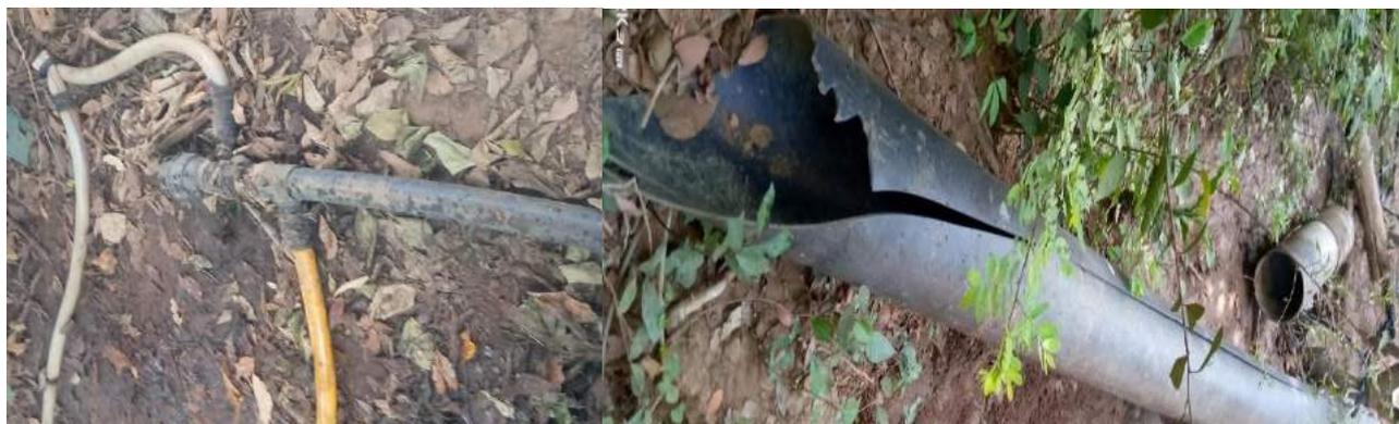
*Photo 10.2. Deux raccords connectés à un secondaire et un tuyau 200mm fendu à cause de la forte pression ; il était connecté à une machine de 6 cylindres pour irriguer un périmètre de 4 ha.*
