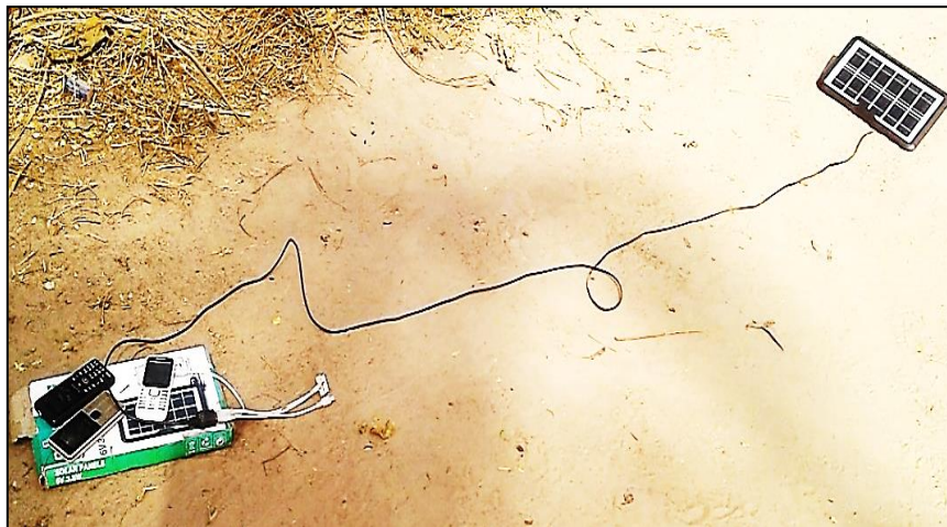
Photo 17 : Rechargement de téléphones portables à l'aide d'un mini panneau solaire à Kahème (Source : Coly, janvier 2020)
