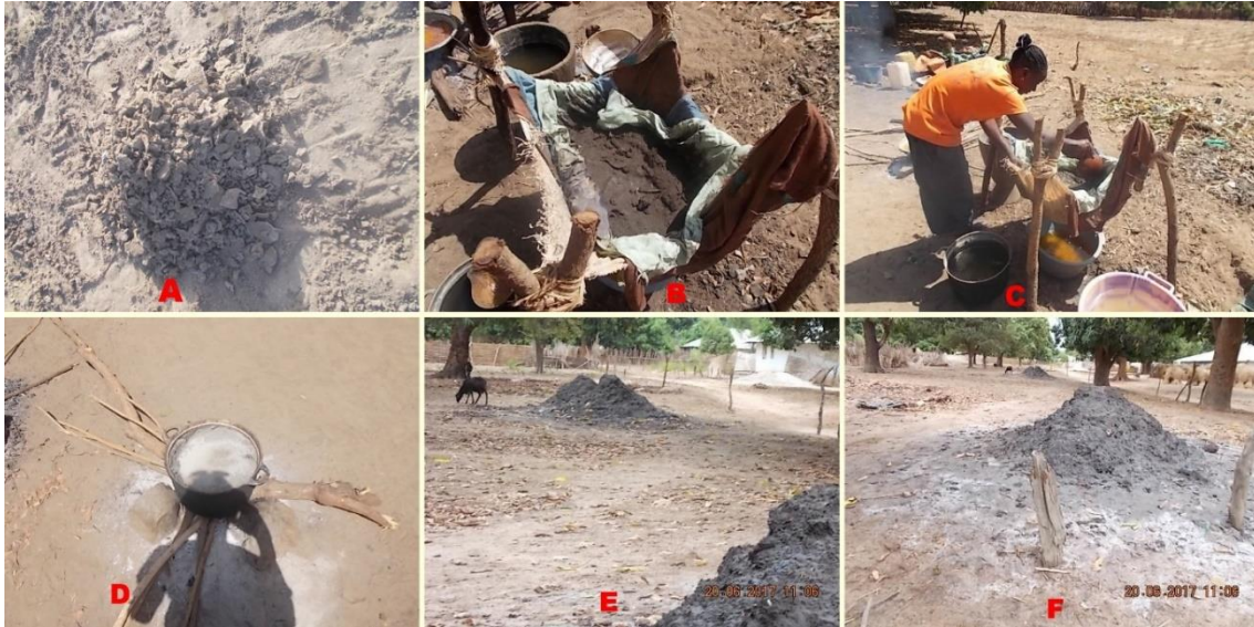
Photo 10: différentes phases de la saliculture dans la commune de Djibanar : chauffage (A), filtration (B et C), chauffage de la saumure (D) et rejet de la boue de filtration (F) (cliché Mansaly, 2017)
