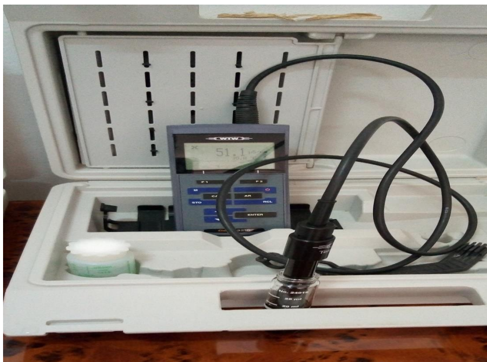
L'appareil utilisé pour mesurer la conductivité des complexes.
