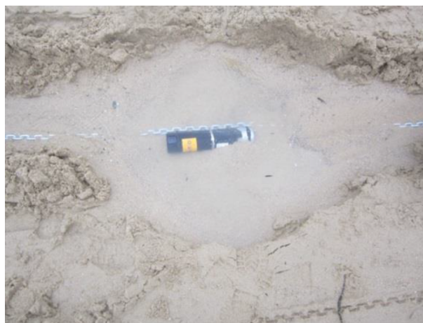
Fig. 2.3 – Capteur de pression déployé lors de la campagne. Le capteur est attaché le long d'une chaîne grâce à des colliers en métal. Le maintien de la chaîne sur le site est assuré par des vis à sable (Caulet (2018), Journal of Coastal Research).
