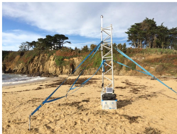
Fig. 2.2 – Photographie de l'installation du LIDAR profileur sur la plage (Caulet (2018)).
