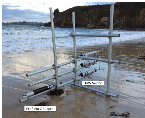
Fig. 2.1 – Module de mesure des courants déployé sur la plage de Porsmilin à 2km du large, lors de la campagne DYNATREZ 2 (Caulet (2018)).
