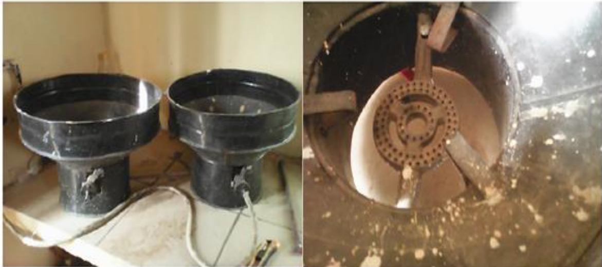
Figure 3. 5: Brûleur a biogaz fabriqué localement
