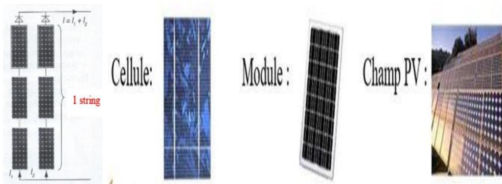
Figure II 1 1cellules, modules et champ panneaux photovoltaïques<sup>vii</sup>
