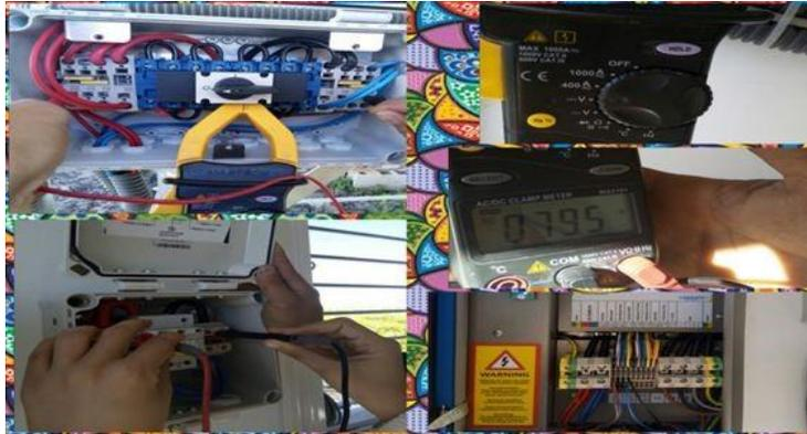
*Figure II 34– Mesure des courants et des tensions*
